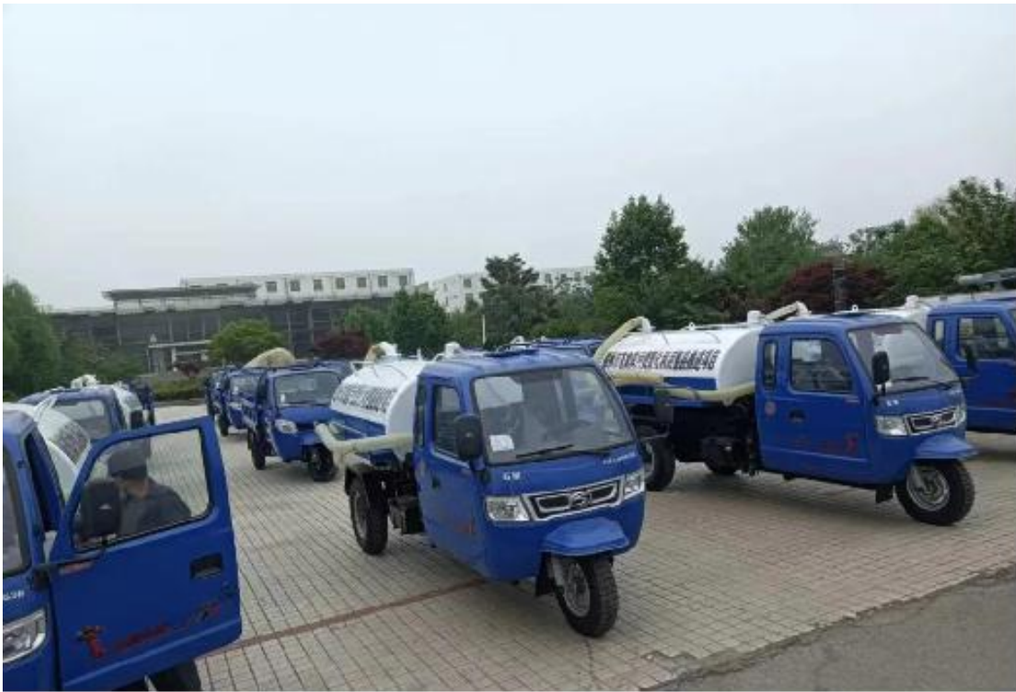
图4-7 粪污收集转运设施
